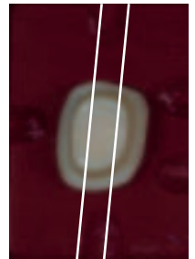
Herstellung der Schnitte parallel zur Fräsrichtung
